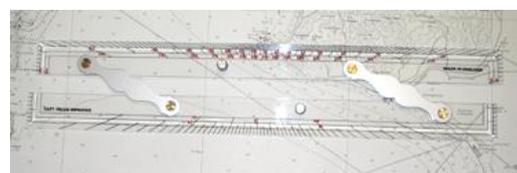
Parallela a snodo in perspex trasparente senza graduazione
